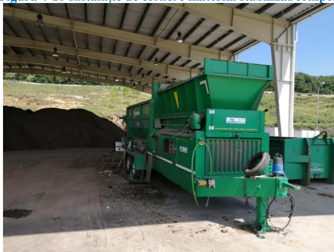
Figura 4-16 Instalație de cernere material stabilizat/compost
